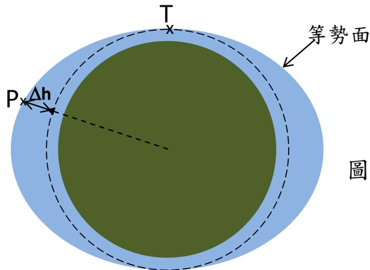
潮汐發生後，海水水面必是一等勢面 (equipotential surface)，此等同我們在 P.35，章節 6 所說的引潮力必垂直於水面。等勢面的「勢」是指「地球的引力勢」加「引潮勢」（引力勢是每單位質量的引力勢能，即是  $mgh/m = gh$ ）。我們分別以  $V_{\text{地引}}$  和  $V_{\text{月潮}}$  表示這兩種勢。考慮上圖 P、T 兩點，它們的勢相同，所以
