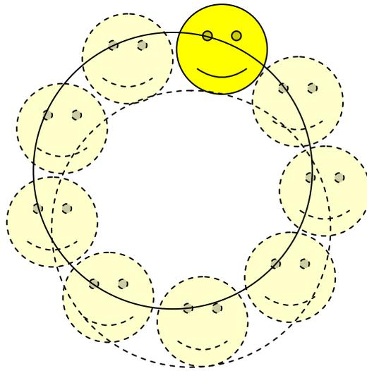
所謂在圓形軌跡上的平移運動，就像 😊 在固定方向下走了一圈。😊 的任何部份都進行完全相同的運動 (**相同半徑但不重疊的圓形**)。
