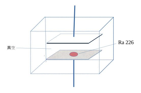
放在真空盒子裏的平行金屬板的其中一塊塗上輻射物。此裝置是最簡單的一個利用輻射而製造的原子能電池(atomic battery)。現有一例。
