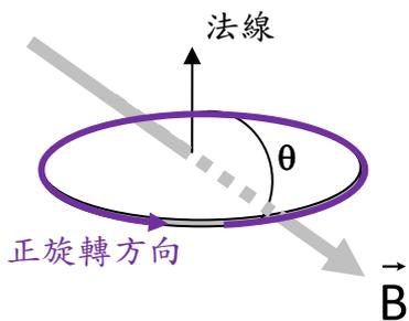
假設圖中的  $B$  隨時間增強。  $90^\circ < \theta < 180^\circ$ ，
