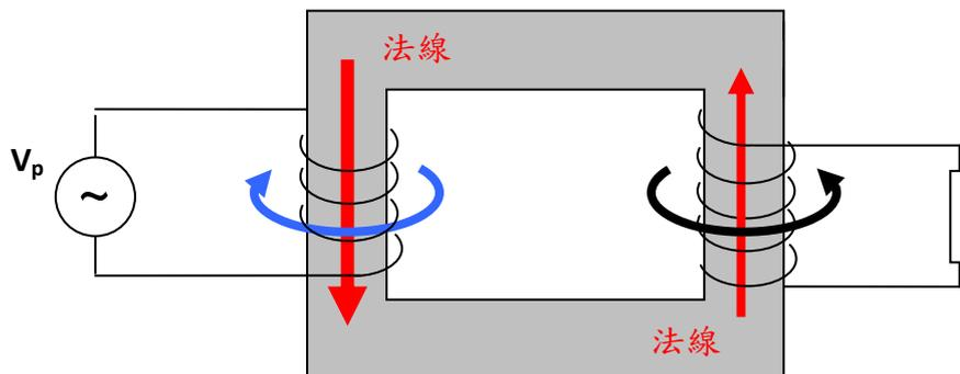
若原線圈的黑點放在下端，那副線圈的黑點就應放在上端。
