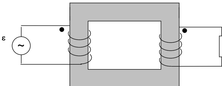
(D) 有一點要鄭重聲明：以上說的「由這感生電壓而產生的感生電流」的感生電流不一定真的會出現。我們只是利用這個感生電流來定感生電壓的極性。
