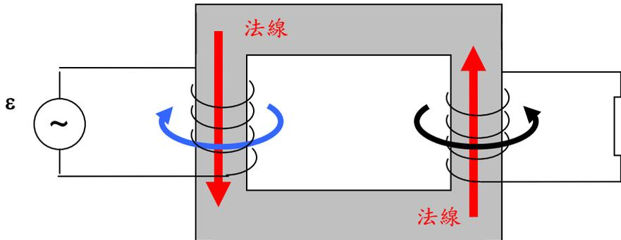
這個感生電壓比 “ $V_p : V_s = N_p : N_s$ ” 是正的。意謂由這感生電壓而產生的感生電流就是一起沿線圈自己的正繞方向流動，或是沿正繞方向的反方向流動。根據電動勢 (electromotive force) 的定義，電動勢源 (seat of electromotive force) 的電流流出端就是正極。
