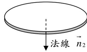
事實是用哪一支法線都可以，但法線的選擇，亦同時決定了線圈上哪一個旋繞的方向是正。使用的是 right hand screw rule。
